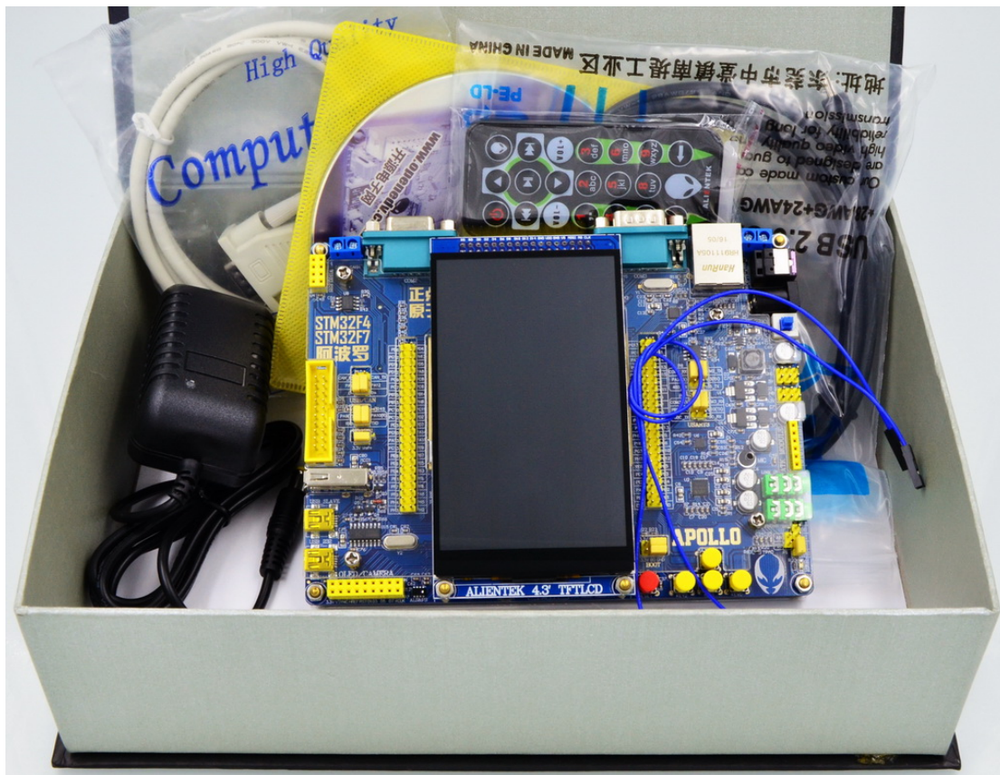
图 1.3 阿波罗 STM32F429 开发板标准套餐配件
